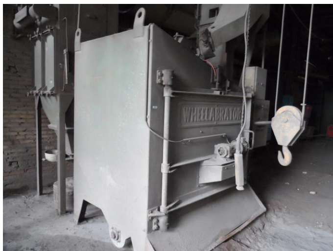
Item 37: Jato de Granalha c/ Painel de Comando e Silo de Alimentação. Marca Whellabrator.
