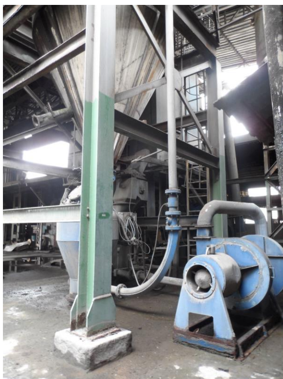
Item 16: Exaustor, Marca Ar Center, Com Motor e Mesa Vibratória com Cilo.
