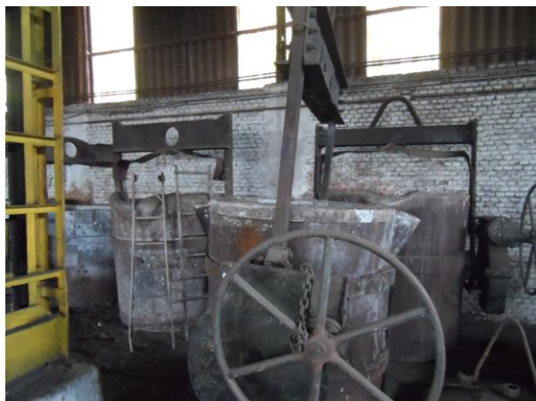
Item 10: Painelas de Fundição com Acionamento Mecânico.
