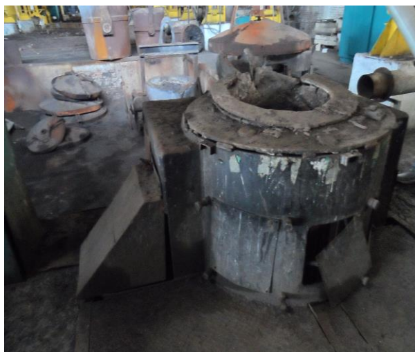
Item 8: Fornos Modelo Cadinho Com Acionamento Hidráulico.
